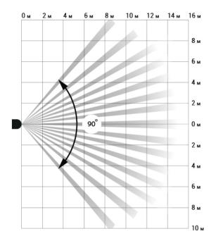
Обязательно удостоверьтесь, что никакие преграды не перекрывают обзор датчика. Учитывайте, что MotionCam Outdoor не определяет движение за стеклом. Поэтому не устанавливайте датчик в местах, где открытое окно или дверь могут ограничивать обзор устройства.
