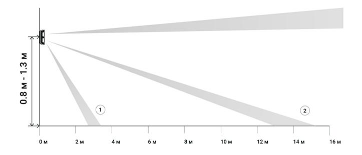
Дальность детекции регулируется ползунком **Detection Distance** на задней панели датчика. При выборе места установки учитывайте максимальную дальность обнаружения датчика. Она зависит от чувствительности, положения ползунка дальности обнаружения (Detection distance), типа и скорости движения человека (бег, ходьба), а также температуры окружающей среды.
