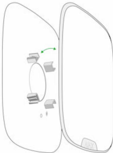
**10.** Зафиксируйте Brandplate на защитной пластиковой панели, прикрутив Brandplate комплектным болтом.
