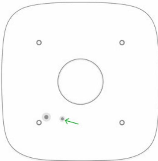
**11.** Установите защитную пластиковую панель на место (логотип Ajax со стороны подключения светодиодной ленты к плате), приложив незначительное усилие. При правильной установке пластиковая панель будет выступать над LED-рамкой не более чем на 1,0–1,5 мм.
