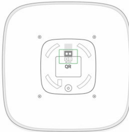
6. Положите сирену лицевой стороной на твердую поверхность и открутите 4 шурупа на задней панели крестовой отверткой PH2.
