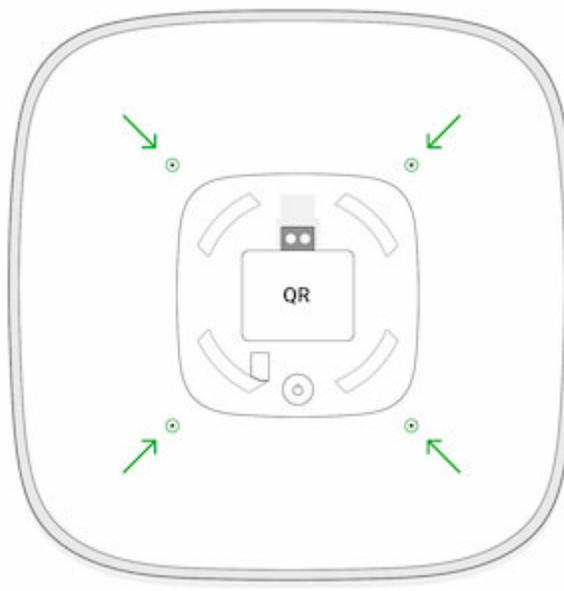
7. Переверните сирену, придерживая лицевую и тыльную стороны корпуса. Снимите защитную пластиковую панель.
