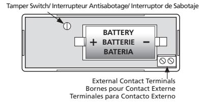
**NOTE: Use only the following batteries/uti-lisez seulement les batteries suivantes/use solamente estas baterías: Panasonic CR-2 or Duracell CR-2 Lithium.**
